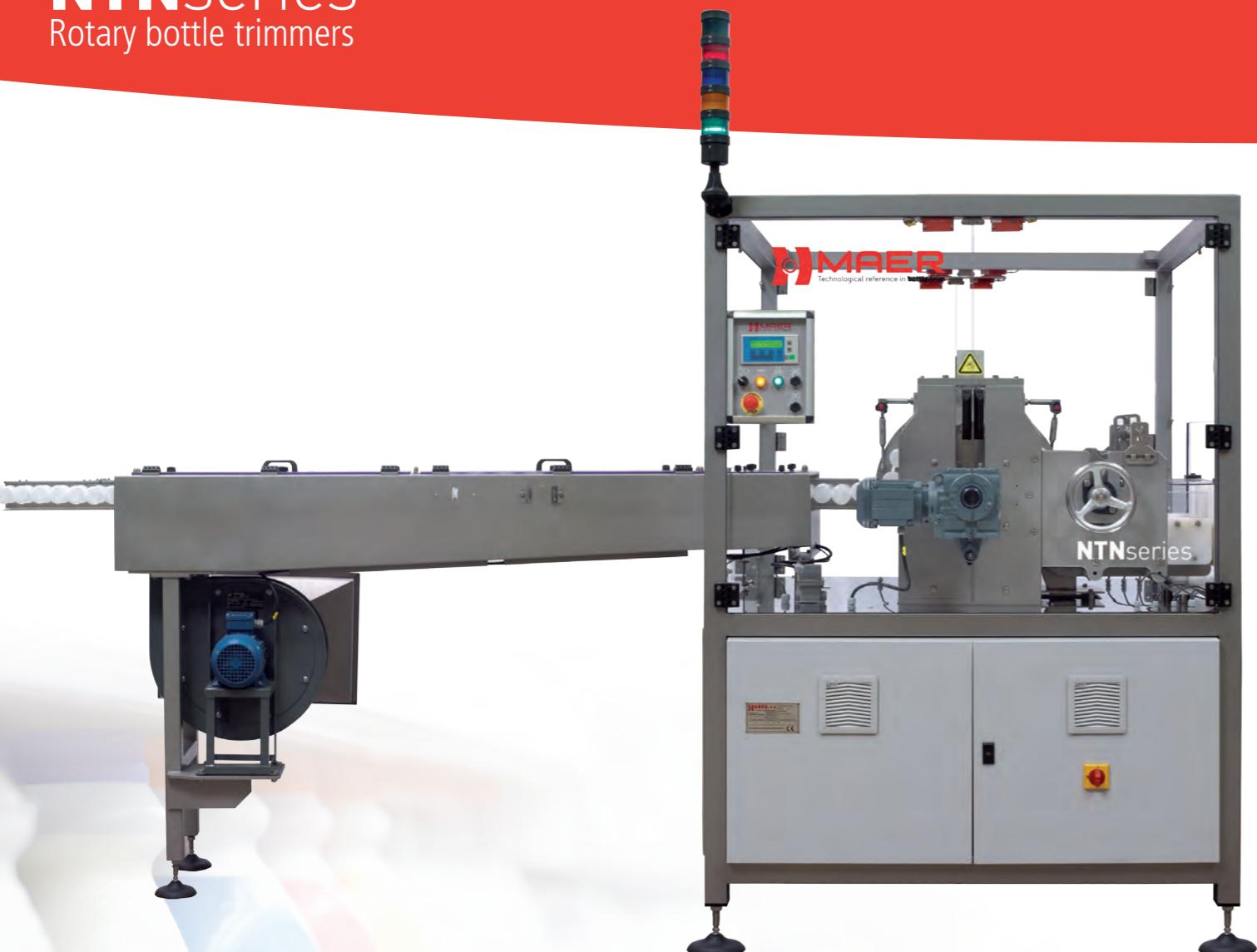
La cortadora rotativa de envases **NTN** permite el corte de la cúpula que comparten dos botellas unidas por el cuello procedentes de un mismo molde, botellas en formato tandem conocidas como "Logs" o "Neck to Neck".
