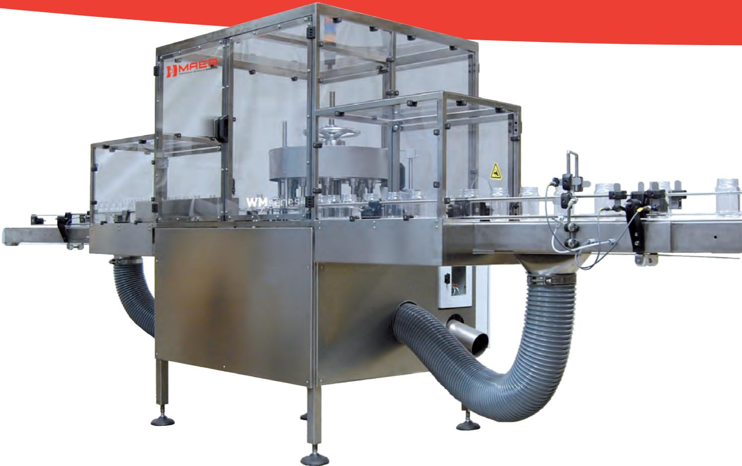
MAER aplica su tecnología rotativa de corte de botellas utilizada en la fabricación de envases de HDPE, también para el corte de tarros de boca ancha de PET fabricados con tecnología Blow-Trim.
